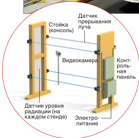
Стандартный портовый детектор радиации производит контроль груза. Чувствительные датчики контролируют уровень радиации, в то время как камера фиксирует номер контейнера
